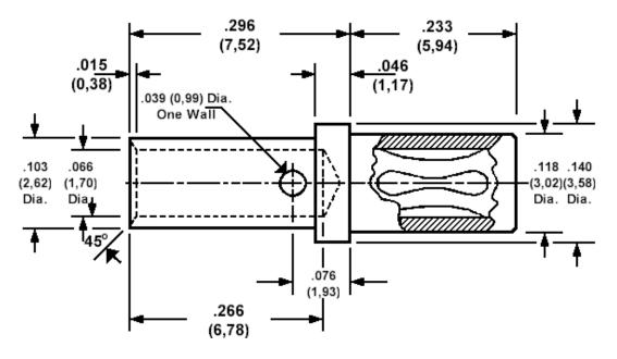
Min hole depth (socket) .190 (4,83)
