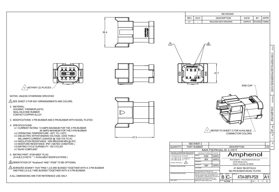
P/N AT04-08PA-P028 KEY-A CONFIGURATION STANDARD COLOR: GREY P/N AT04-08PB-P028 KEY-B CONFIGURATION STANDARD COLOR: BLACK P/N AT04-08PC-P028 KEY-C CONFIGURATION STANDARD COLOR: GREEN P/N AT04-08PD-P028 KEY-D CONFIGURATION STANDARD COLOR: BROWN
