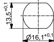
Minimale Wandstärke 1,5mm, alternativ Frontplattenausschnitt d=16,1
