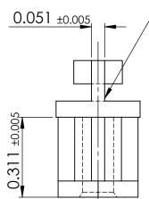
3.1 DIA. HOLE FOR M3.5 **SELF TAPPING SCREW** (TYPE B RECCOMENDED)
