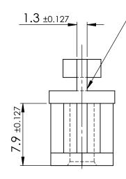
3.1 DIA. HOLE FOR M3.5 SELF TAPPING SCREW (TYPE B RECCOMENDED)
