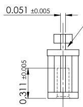
3.1 DIA. HOLE FOR M3.5 SELF TAPPING SCREW (TYPE B RECCOMENDED)
