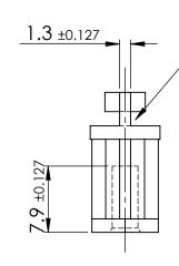
3.1 DIA. HOLE FOR M3.5 SELF TAPPING SCREW (TYPE B RECCOMENDED)
