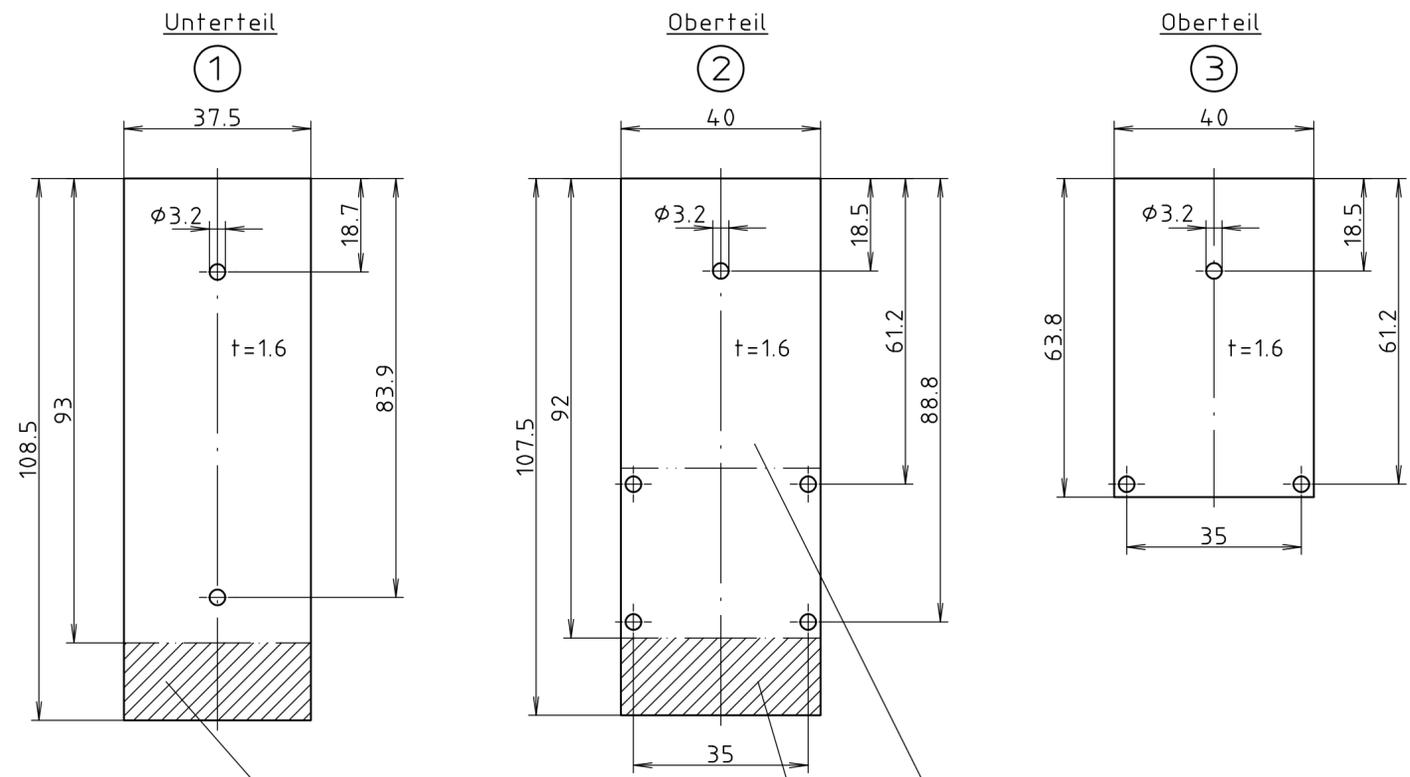
Bei pultförmiger Anwendung entfällt der schraffierte Bereich wahlweise bei Platine 1 oder Platine 2.
