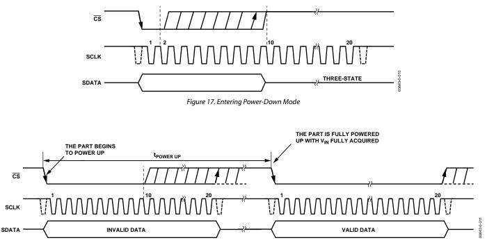
Figure 18. Exiting Power-Down Mode
