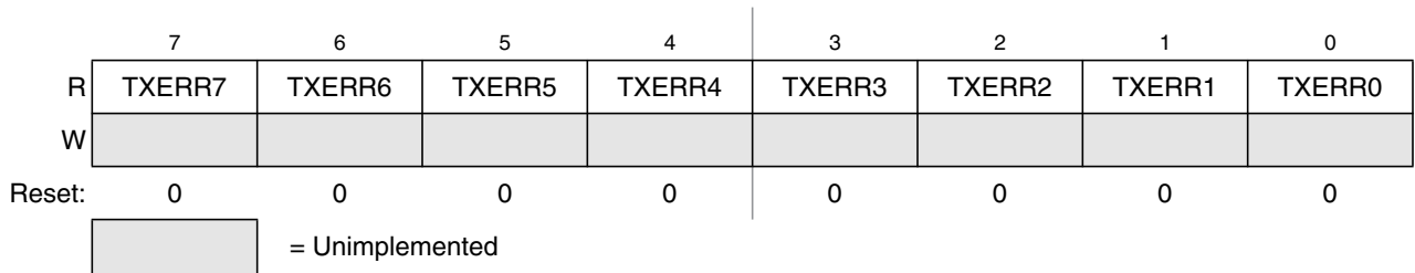
Figure 10-17. MSCAN Transmit Error Counter (CANTXERR)
