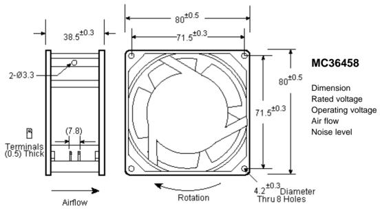
: 80 x 80 x 38mm : 220V ac 50/60 Hz. : 200-240V ac. : 31 CFM.
