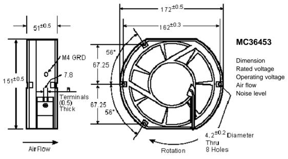
: 115V ac 50/60 Hz. : 90-125V ac. : 240 CFM. : 48dBA.
