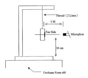
1 METER FROM MICROPHONE TO FAN INTAKE
