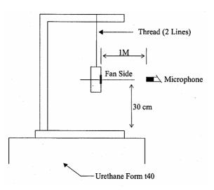
1 METER FROM MICROPHONE TO FAN INTAKE
