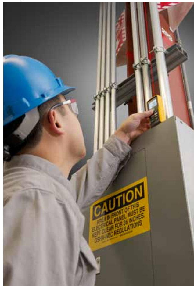
Pomiar odległości do wysokiego sufitu.
