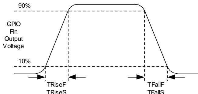
**Figure 3-8. GPIO Timing Diagram**
