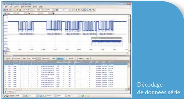
Les oscilloscopes PicoScope 6000 sont parfaitement adaptés au décodage sériel grâce à une mémoire tampon importante qui leur permet de collecter de longues séquences de données ininterrompues. Ainsi, vous pouvez capturer des milliers de trames ou paquets de données en quelques secondes. Les oscilloscopes peuvent décoder jusqu'à quatre bus simultanément avec une sélection de protocoles indépendante pour chaque voie d'entrée.
