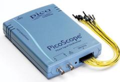
Los PicoScope serie 3000 MSO de Pico Technology son osciloscopios de 2 + 16 canales de 8 bits de resolución. Con 2 canales analógicos, los PicoScope serie 3000 MSO también tienen 16 entradas digitales, de manera que pueda ver de manera simultánea sus señales analógicas y digitales.
