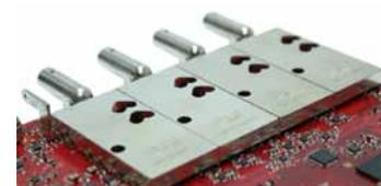
El cuidadoso diseño y la protección de la parte frontal reducen el ruido, las interferencias cruzadas y la distorsión armónica. Años de experiencia en la fabricación de osciloscopios han dado como resultado una mejora en la respuesta de impulso y la planeidad del ancho de banda.
