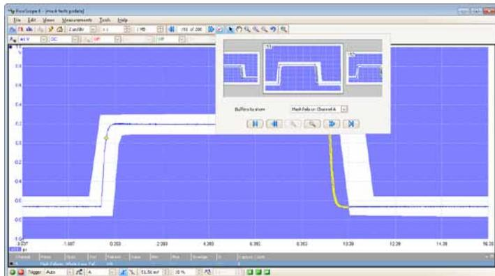
Conecte el sistema que se esté comprobando y PicoScope resaltará todas las partes de la forma de onda que queden fuera de la máscara. Los detalles resaltados permanecerán en la pantalla para que el osciloscopio pueda captar perturbaciones intermitentes mientras usted trabaja en algo diferente. La ventana de mediciones cuenta el número de fallos y puede mostrar simultáneamente otras mediciones y estadísticas. Se pueden importar y exportar máscaras como archivos.
