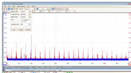
Con un solo clic, puede mostrar un trazado de espectro de los canales seleccionados con una frecuencia máxima de hasta 200 MHz. Toda una gama de ajustes le permite controlar las bandas de espectro, los tipos de ventana y los modos de visualización: instantáneo, promedio, o de pico mantenido.
