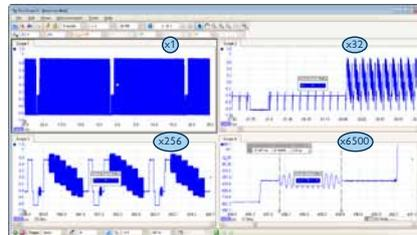
de tiempos largos. Usando este buffer de 512 MS, PicoScope 5444B puede realizar muestras a 1 GS/s hasta 50 ms/div (tiempo total de captura de 500 ms).
