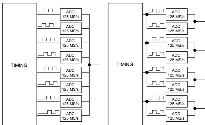
En modo paralelo, se muestrean varios ADC en fase en cada canal aumentando la resolución a 14 bits (ver diagrama) a 125 MS/s por canal (70 dB SFDR). Si solo se requieren dos canales, entonces la resolución se puede incrementar hasta 15 bits, y en modo de canal único todos los CAD se combinan para ofrecer un modo de 16 bits a 62,5 MS/s.
