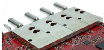
Die ausgereifte Front-End-Konstruktion und Schirmung reduzieren das Rauschen, Kreuzkopplungen und den Klirrfaktor. Auf der Grundlage unserer langjährigen Erfahrung in der Entwicklung und Herstellung von Oszilloskopen bieten wir Ihnen Geräte
