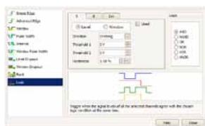
Zusätzlich zu den Standard-Triggerern herkömmlicher Oszilloskope bietet die PicoScope 5000-Serie eine branchenführende Reihe von erweiterten Triggern einschließlich von Impulsbreiten-, Fenster- und Aussetzer-Triggern, mit denen Sie gezielt die gewünschten Daten erfassen können.
