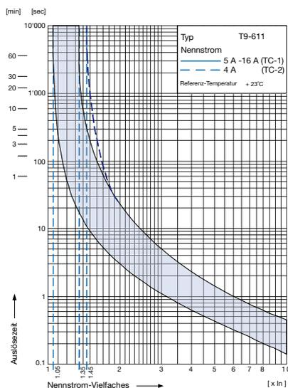
Abbildung 5: Auslösekennlinie Geräteschutzschalter T9
