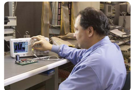
Figura 3. La classica funzione di test con maschera passa/non passa è solo una delle ragioni per cui la serie 1000 si adatta bene ai collaudi di produzione e ai controlli effettuati nei laboratori di assistenza.
