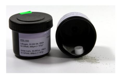
Lotkugeln höchster Qualität ermöglichen zuverlässige Reballing Ergebnisse. Die Lotkugeln werden in Mengen zu 50.000 St. unter Argon Gas verpackt ausgeliefert. Die Verpackung unter trockenem Argon Gas verhindert ungewünschte Oxidation der Lotkugeln während der Lagerzeit. Oxidierte Lotkugeln haben ein schlechteres Benetzungsverhalten auf den Kontaktflächen und bilden mehr und größere Voids in den umgeschmolzenen Lotballs aus. Die Dosen sind per Schraubdeckel praktisch wiederverschließbar.
