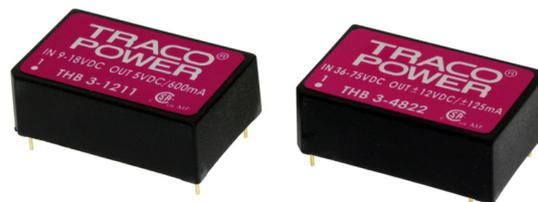
Die THB-3 Serie bietet eine sehr leistungsfähige Generation, geregelter DC/DC-Konverter in einem DIL-24 Kunststoffgehäuse. Die verstärkte E/A-Isolierung und der weite 2:1 Eingangsbereich machen sie zur optimalen Lösung für den Transport- und Industriebereich, sowie medizin- bzw. messtechnische Applikationen, also überall dort wo sehr hohe Isolationsspannungen, eine verstärkte Isolierung und besondere Sicherheitsstandards erforderlich sind.
