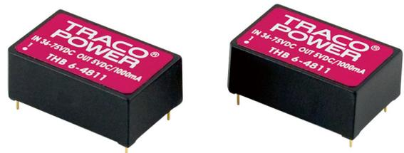
Die THB 6 Serie bietet leistungsfähige, geregelte DC/DC-Konverter in einem DIL-24 Kunststoffgehäuse. Die verstärkte E/A-Isolierung und der weite 2:1 Eingangsbereich machen sie zur optimalen Lösung für den Transport- und Industriebereich, sowie, medizin- bzw. messtechnische Applikationen. Also überall dort wo eine sehr hohe Basis-, zusätzliche oder verstärkte Isolierung gebraucht wird und besondere Sicherheitsstandards benötigt werden.
