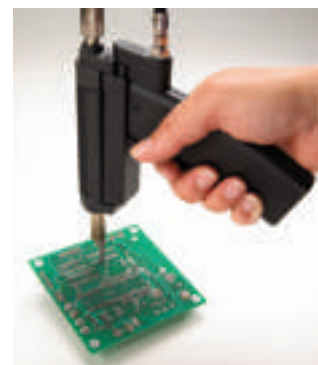
Dessoudage de composants traversants avec la poignée MX-DS1.
