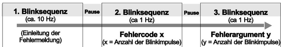
Abbildung 57: Codierung der Fehlermeldung
