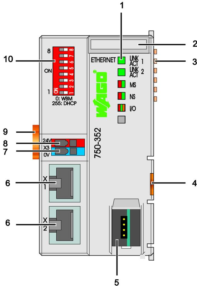
Abbildung 21: Ansicht ETHERNET TCP/IP-Feldbuskoppler
