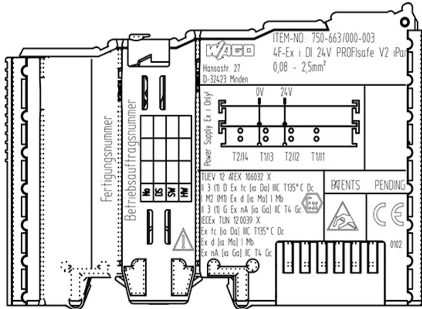
Abbildung 63: Beispiel für die seitliche Bedruckung der ATEX- und IECEx-zugelassenen Ex i Busklemmen.
