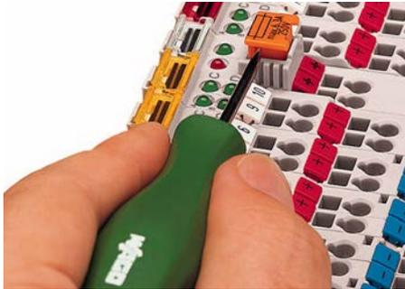
Abbildung 9: Sicherungshalter ziehen
