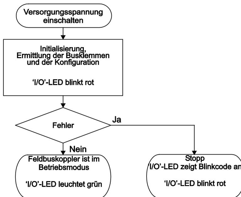
Abbildung 35: Betriebssystem Feldbuskoppler
