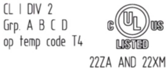
Abbildung 66: Textdetail - Beispielbedruckung der Busklemmen gemäß NEC 500
