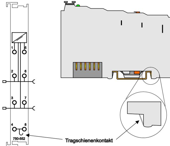
Abbildung 17: Tragschienenkontakt
