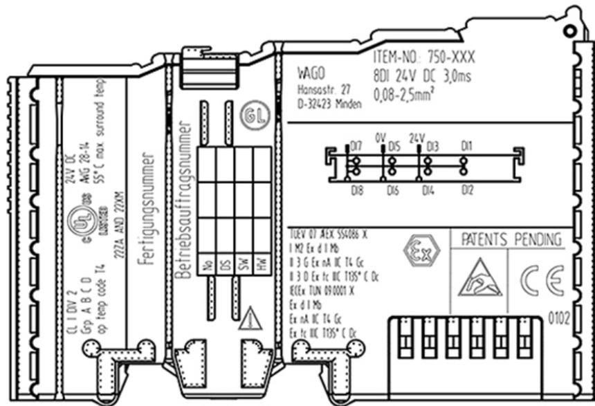
Abbildung 65: Beispiel für seitliche Bedruckung der Busklemmen gemäß NEC 500
