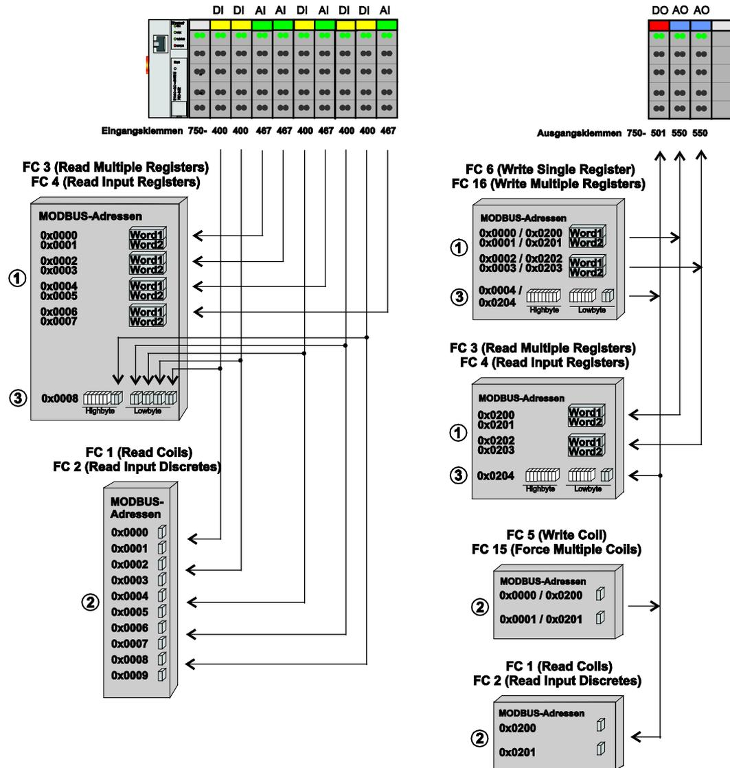
Abbildung 59: Anwendung von MODBUS-Funktionen für einen Feldbuskoppler/-controller
