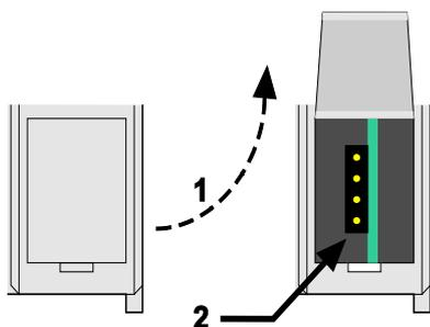
Abbildung 25: Service-Schnittstelle zur Konfiguration (geschlossene und geöffnete Klappe)
