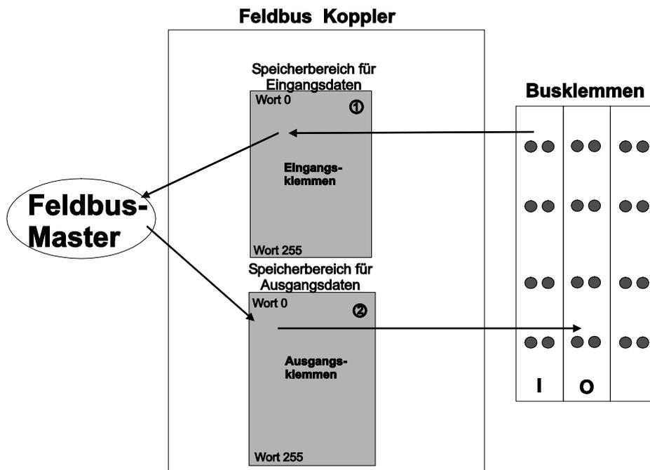
Abbildung 36: Speicherbereiche und Datenaustausch für einen Feldbuskoppler
