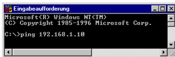
Abbildung 43: Beispiel für den Funktionstest eines Feldbusknotens
