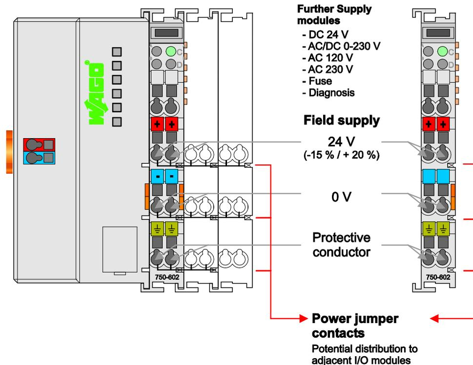
Abbildung 7: Feldversorgung (Sensor/Aktor)
