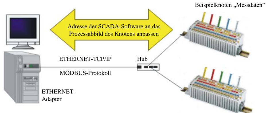
Abbildung 60: Beispiel SCADA-Software mit MODBUS-Treiber
