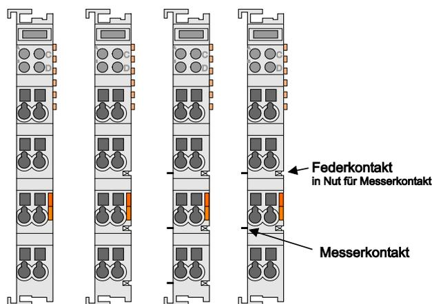
Abbildung 33: Beispiele für die Anordnung von Leistungskontakten
