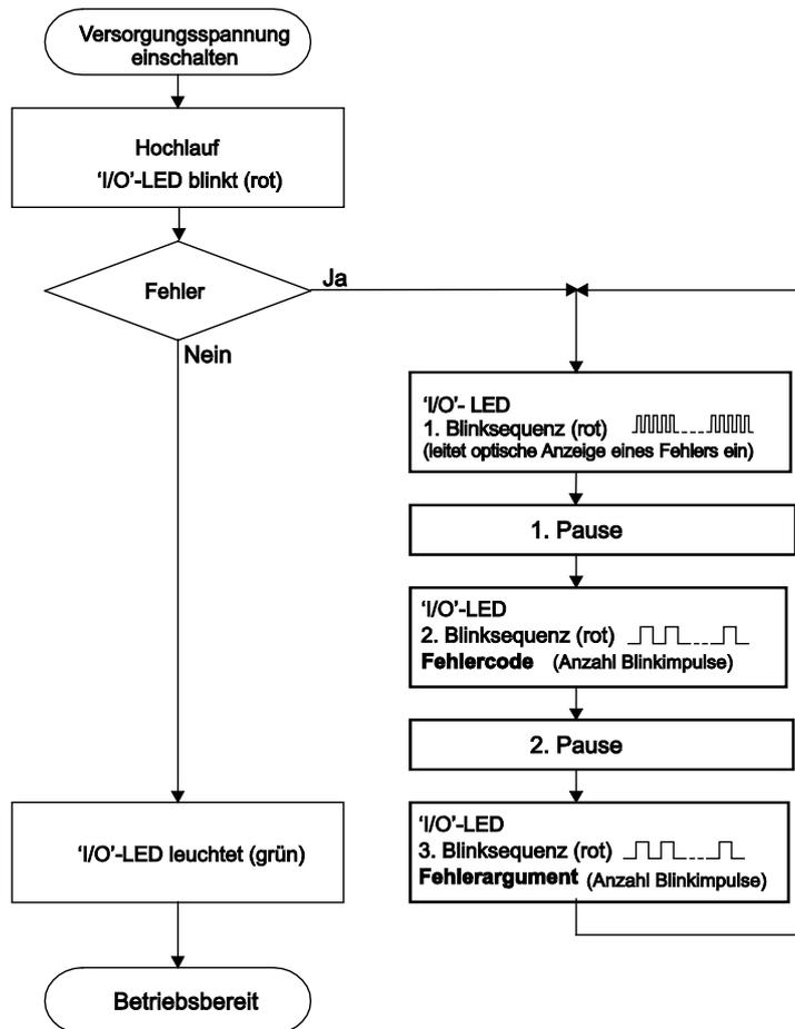
Abbildung 56: Knotenstatus - Signalisierung der I/O-LED
