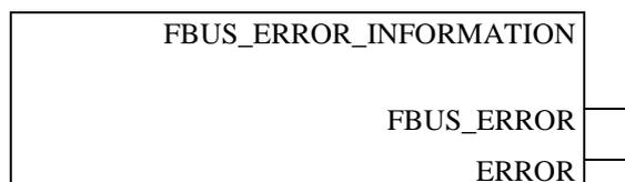
Abbildung 58: Funktionsblock zur Ermittlung des Feldbusausfalls
