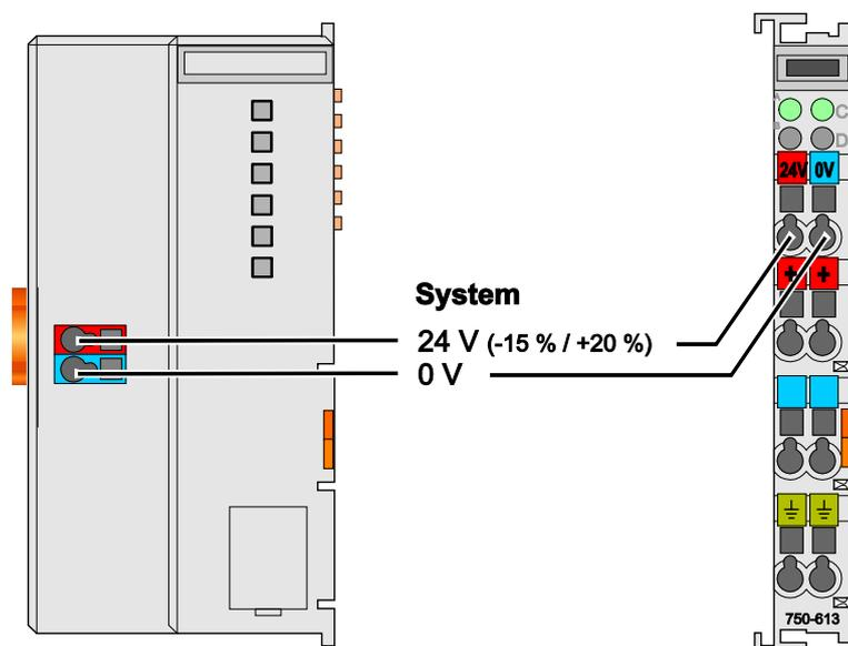
Abbildung 5: Systemversorgung für den Feldbuskoppler
