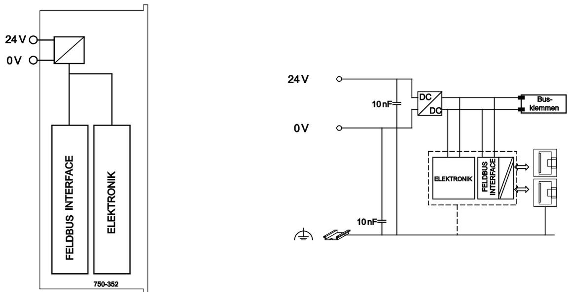
Abbildung 22: Geräteinspeisung
