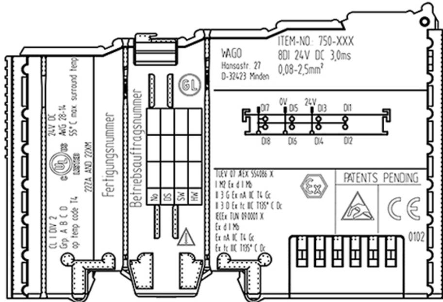
Abbildung 61: Beispiel für die seitliche Bedruckung der ATEX- und IECEx-zugelassenen Busklemmen.
