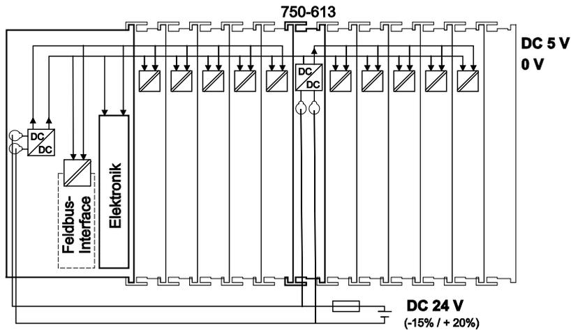
Abbildung 6: Systemspannung
