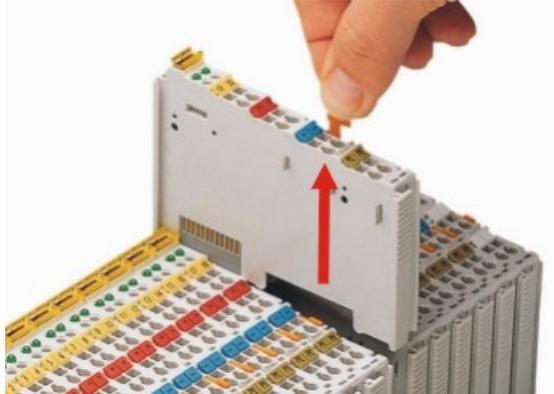
Abbildung 31: Busklemme lösen
