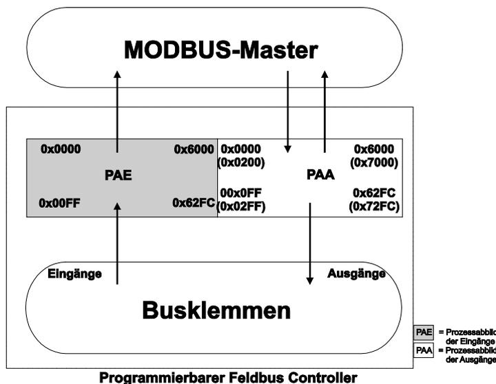
Abbildung 37: Datenaustausch zwischen MODBUS-Master und Busklemmen
