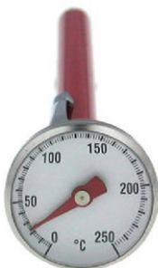
Los termómetros bimetalicos de disco son una alternativa de los termómetros de vidrio y están fabricados en acero inoxidable que los hace convenientes para los productos alimenticios. Estos instrumentos tienen un disco de 24mm con una punta en acero inoxidable de 125mm, así mismo cuenta con una armadura de bolsillo con que puede ser utilizado para manipular el termómetro. Otros tamaños de disco están disponibles bajo petición.
