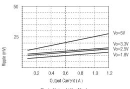
Ripple Vs Load (Vin=Max)
