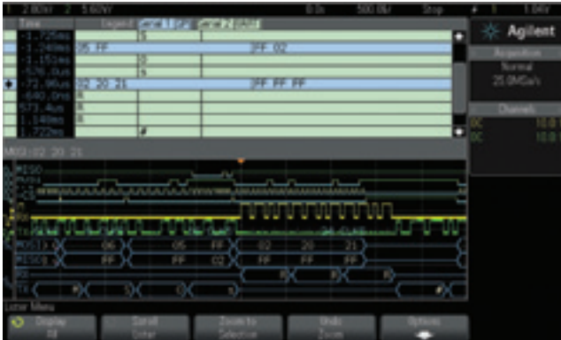
Figure 3 : Un "Lister" entrelacé facilite la corrélation temporelle de l'activité entre deux bus série décodés.
