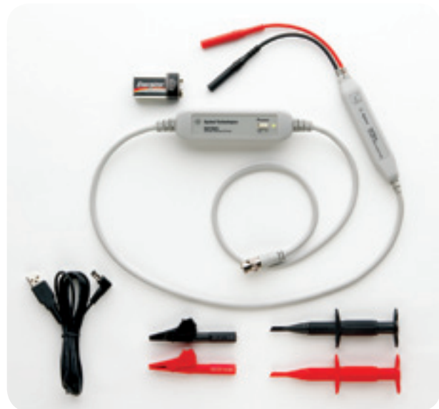
Figure 9 : Sonde active différentielle 200 MHz Agilent N2792A
