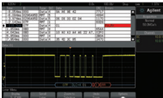
Figure 1 : Le décodage matériel révèle rapidement les erreurs de communication série.
