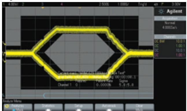
Figure 7 : Test de gabarit de diagramme de l'œil ARINC 429 100 kbits/s.
