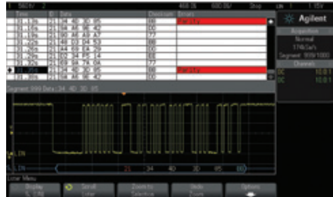
Figure 4 : L'acquisition en mémoire segmentée capture sélectivement plus de paquets/octets d'activité du bus série.
