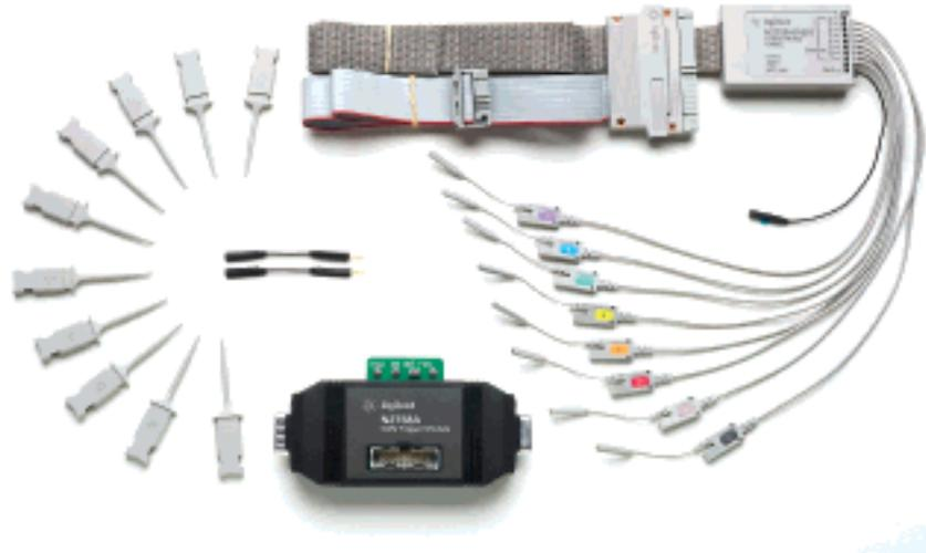
Das Kit N2758A enthält das CAN-Trigger-Modul, ein Digitalkabel, zehn Abtaster und zwei Tastkopf-Erdleitungen.
