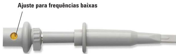
Figura 1. Ajuste de compensação de frequências baixas.
