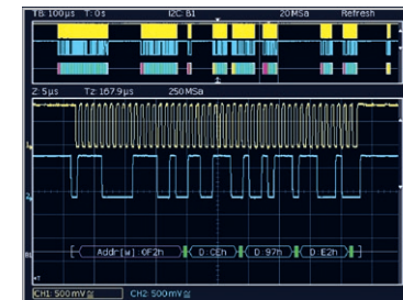
I 2 C Bus Hex Dekodierung auf dem Analog-Kanal
