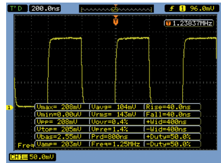
Figure 7. Affichage simultané à l'écran de toutes les mesures mono-voies
