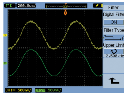
Figure 9. Le signal de la voie 1 (en jaune) représente une entrée non filtrée et le signal de la voie 2 (en vert) représente le même signal d'entrée comportant un filtre passe-bas.
