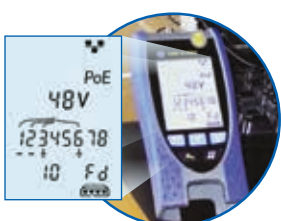
Detección de servicios
