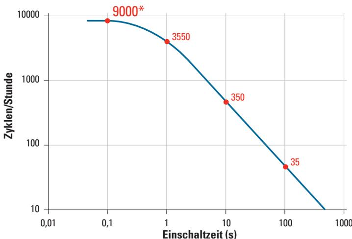
SOLICON-Halbleiter-Schalterschütze verfügen über eine innovative Schalttechnik, die es ihnen ermöglicht, einen Motor mit einer maximalen Start/Stopp-Schaltfrequenz von 9000 Schaltungen/Stunde zu betreiben\* – eine Schaltgeschwindigkeit, die bisher noch von keinem Halbleiter-, elektromechanischem oder Hybrid-Schalterschütz erreicht wurde.
