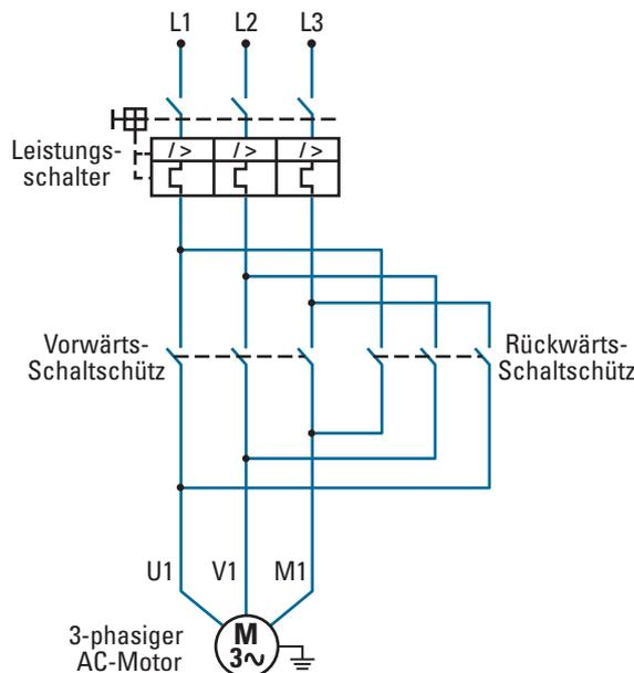
Bei manchen Anwendungen ist es erforderlich, die Drehrichtung des Motors (vorwärts/rückwärts) zu steuern; in solchen Fällen müssen zwei Schaltschütze zusammen mit einer Verriegelung verwendet werden, um unbeabsichtigte Richtungsänderungen zu verhindern.
