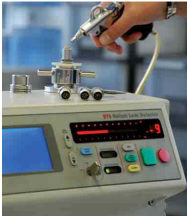
Vacuumtest with leakdetector Vakuumtest mit Leakdetektor
