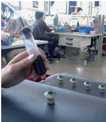
Vacuumtight sealed sockets with Ni-Cr/Ni contacts Hochvakuumdichte Apparatedosen mit Ni-Cr/Ni-Kontakten
