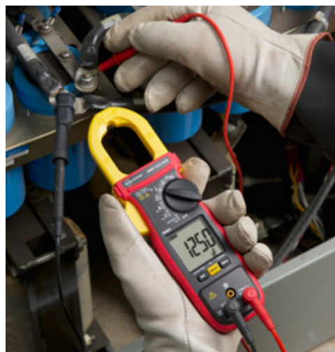
Pince multimètre AC/DC AMP-320-EUR pour la maintenance des moteurs électriques
