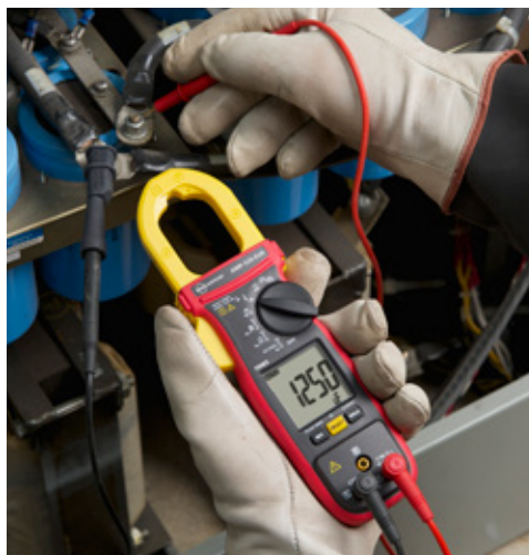
Miernik cęgowy AC/DC AMP-320-EUR do konserwacji silników elektrycznych
