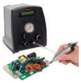
Les doseurs / contrôleurs de la gamme DX-250 sont des systèmes de dosage de fluides par temps et pression fiables, économiques et de haute précision. Ces systèmes de dosage de fluides de précision sont équipés d'un minuteur digital et d'un contrôle de venturi pour tout type de viscosité de fluides.
