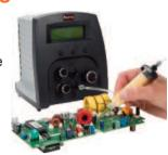
Le DX-350 dispose d'un venturi ajustable pour éviter l'éventuelle formation de goutte entre chaque cycle de dosage
