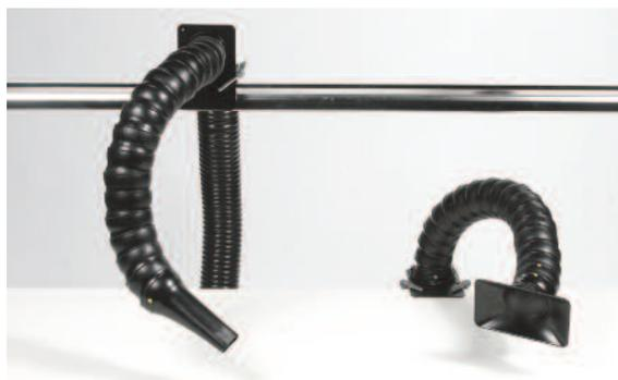
Les bras Omniflex (Ø 63 mm) permettent des débits d'air élevés et une captation efficace des fumées à des distances supérieures. Un système à rotule exclusif leur confère une souplesse de manoeuvre et de positionnement inégalée. La longueur utile ou la portée du bras peuvent se régler par simple ajout ou retrait d'éléments Omniflex. La protection ESD est assurée grâce à l'utilisation d'un matériau conducteur.
