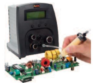
Das Dosiersystem DX-350 bietet die Möglichkeit bis zu 10 Dosierprofile zu speichern. Zeit, Druck und Rückhaltevakuum werden digital angezeigt. Das Gerät ist intuitiv bedienbar und bietet eine hohe Wiederholgenauigkeit bei der Linien-oder Punkt-Dosierung.
