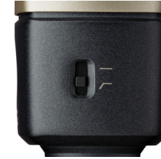
Abbildung 3: Wahlschalter für Tiefenabsenkung
