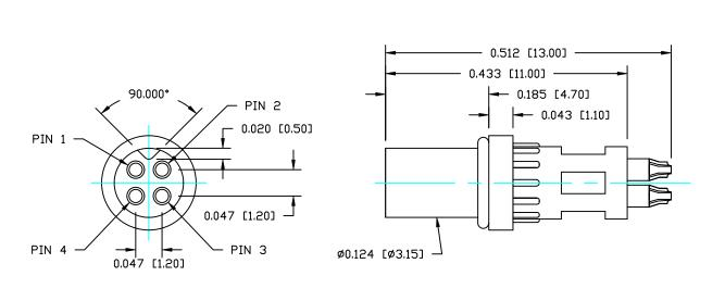
M5 FEMALE - CABLE MOUNT - SOLDER CUP - 4 POSITION
