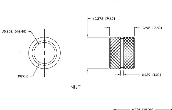
M8 FEMALE - CABLE MOUNT - SOLDER CUP - 5 POS.
