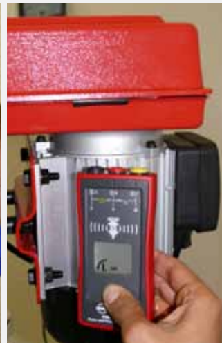
Trådløs deteksjon av motorrotasjon
