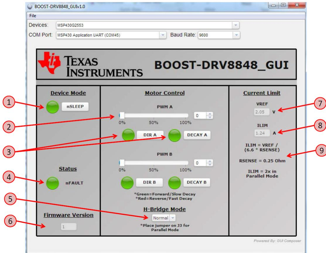
Figure 14. GUI (Normal Mode)
