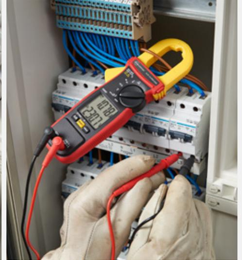
ACD-14-PRO-EUR kann für Spannungsabfallprüfungen und andere Anwendungen Spannung und Strom gleichzeitig messen und auf der großen LCD-Doppelanzeige mit Hintergrundbeleuchtung darstellen.
