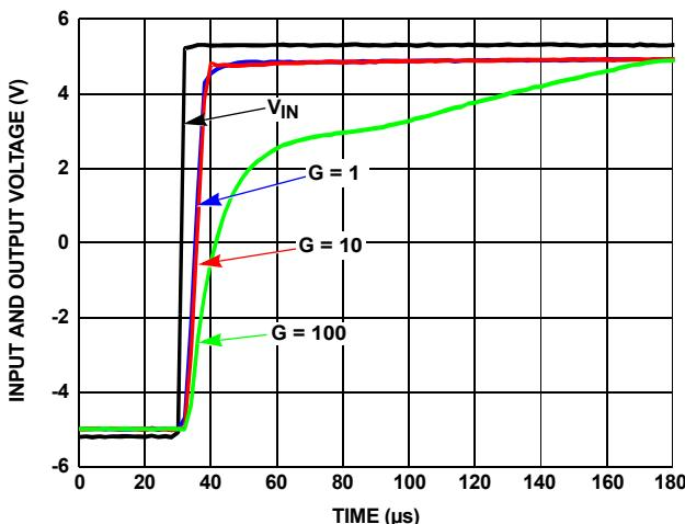
FIGURE 52. NEGATIVE OVERLOAD RECOVERY TIME, ISL2863x
