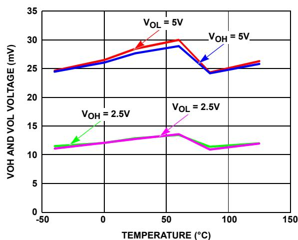
FIGURE 58. OP AMP  $V_{OH}$  AND  $V_{OL}$  vs TEMPERATURE
