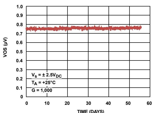
FIGURE 10. PGIA LONG TERM DRIFT OFFSET VOLTAGE
