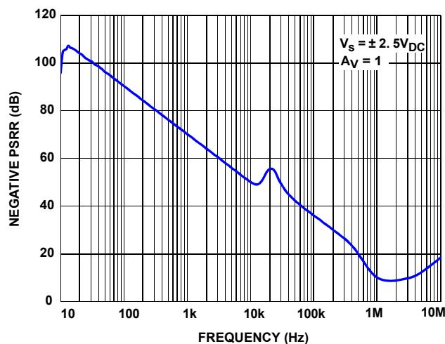
FIGURE 63. OP AMP POWER SUPPLY REJECTION RATIO
