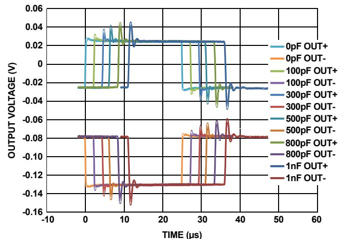
FIGURE 48. CAPACITIVE LOAD OVERRUSH; ISL2863x
