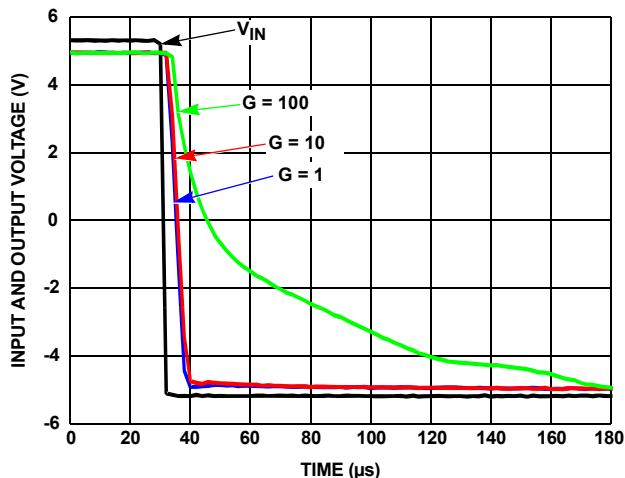
FIGURE 50. POSITIVE OVERLOAD RECOVERY TIME, ISL2863x
