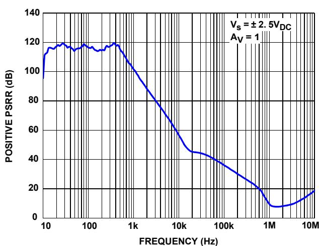
FIGURE 64. OP AMP POWER SUPPLY REJECTION RATIO
