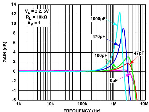
FIGURE 62. OP AMP CAPACITIVE LOAD vs FREQUENCY
