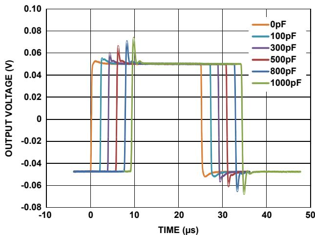
FIGURE 47. CAPACITIVE LOAD OVERRUSH; ISL2853x
