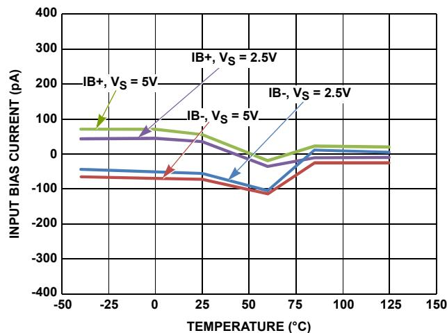
FIGURE 57. OP AMP BIAS CURRENT vs TEMPERATURE
