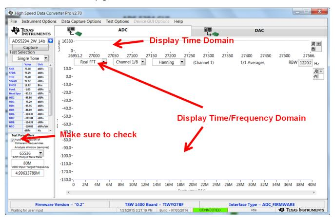
Figure 7. ADS5294 Time Domain Setup
