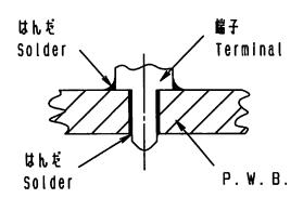
基板に挿入される金属足ははんだ付けしてご使用願います。 Solder all metal inserted fixing including terminals & metal lugs into a substrate.
