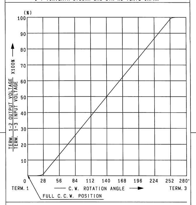
AT 140° C.W. SHAFT ROTATION FROM FULL C.C.W. POSITION VOLTAGE PERCENT SHALL FALL WITHIN THE LIMITS OF 40~60 PERCENT.
