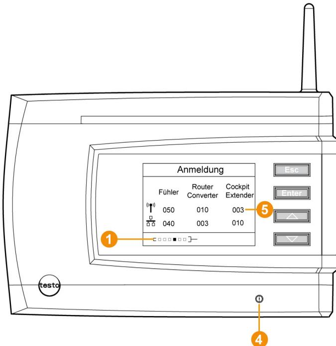
1. An der Saveris Base mit der Taste [▼] bis zum Menü **Info System** wechseln.
